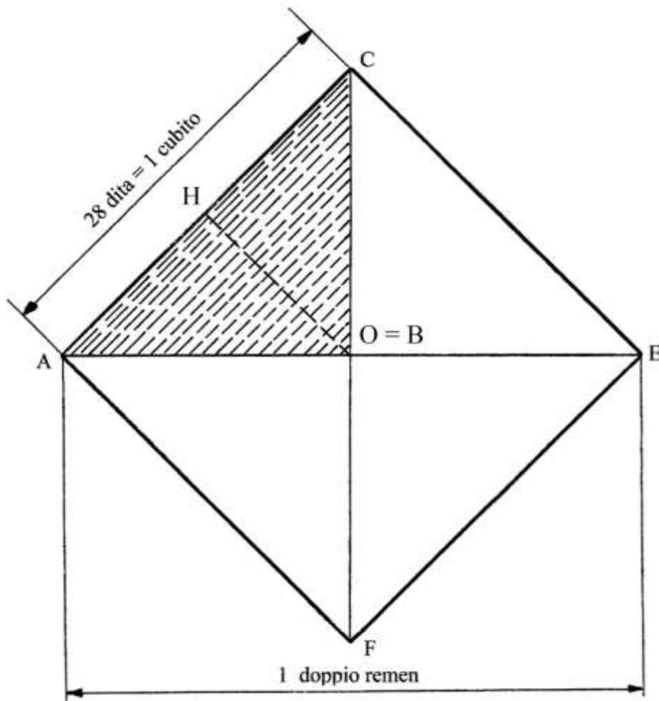
Il triangolo rettangolo isoscele tratteggiato ha l'ipotenusa AC lunga 28 dita e i cateti AB e BC lunghi 1 remen: il poligono riproduce, ruotato in senso antiorario di  $45^\circ$ , il triangolo del primo schema. Esso è un quarto del quadrato di cui fa parte.
