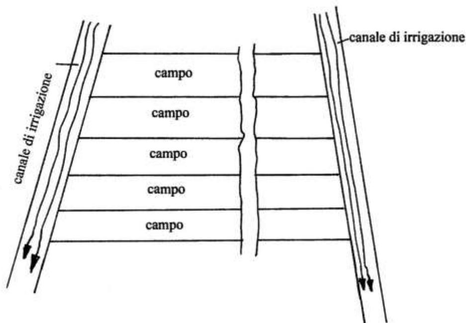
I due canali potevano essere costruiti a livelli leggermente differenti: ad esempio, quello di sinistra poteva essere leggermente più elevato di quello di destra e l'acqua scorreva nei campi da sinistra verso destra, per fluire nel canale a destra.
