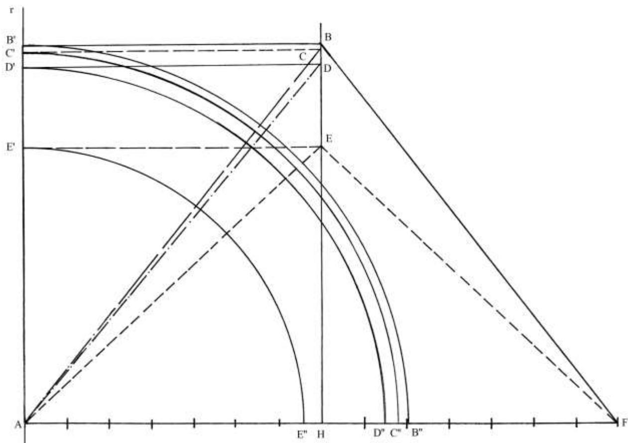
Per il punto A tracciare la retta  $r$ , perpendicolare a AF. Dai punti B, C, D e E condurre verso sinistra linee parallele a AF fino a incontrare  $r$  nei punti B', C', D' e E': essi definiscono le altezze delle tre piramidi e del mucchio di sabbia convenzionale.
