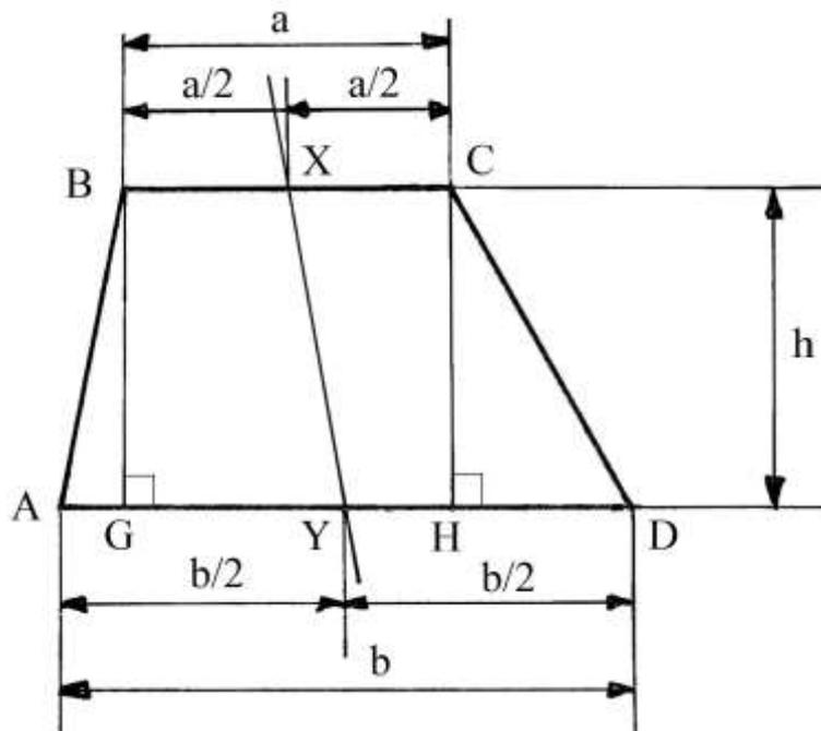
I punti X e Y dividono le due basi in parti uguali. Il segmento XY divide il trapezio ABCD in due trapezi, ABXY e XCDY, di uguale superficie.
