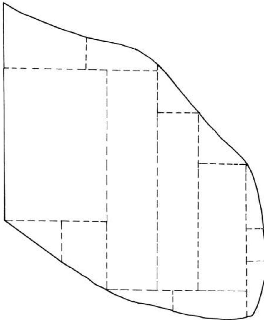
Queste semplici figure geometriche permisero di determinare la superficie delle singole quindici particelle e di sommare i risultati. Gli agrimensori usarono due metodi elementari: le quadrangolazioni e le triangolazioni.
