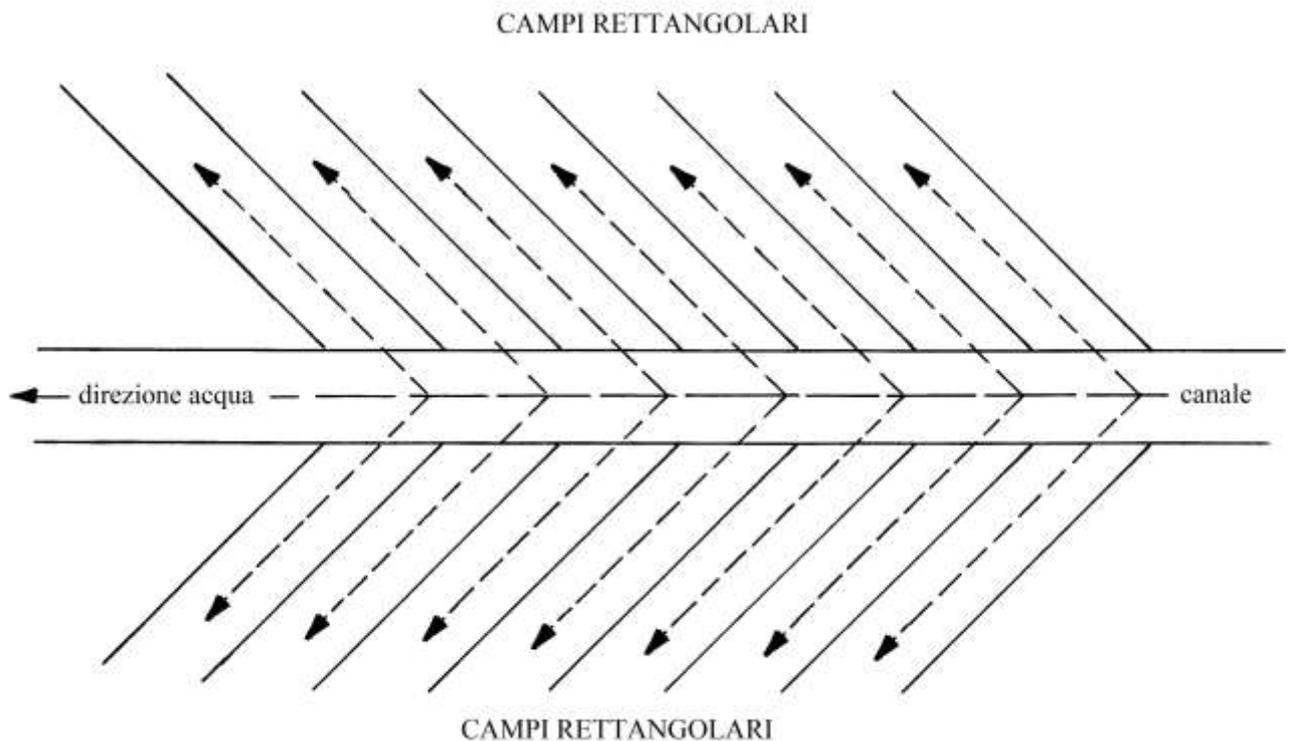
Lo schema è in pianta e i campi sono schematizzati sotto forma di strisce rettangolari fra loro parallele, inclinate di 45° rispetto alla direzione della corrente: i campi hanno la testata disposta lungo le due rive.
