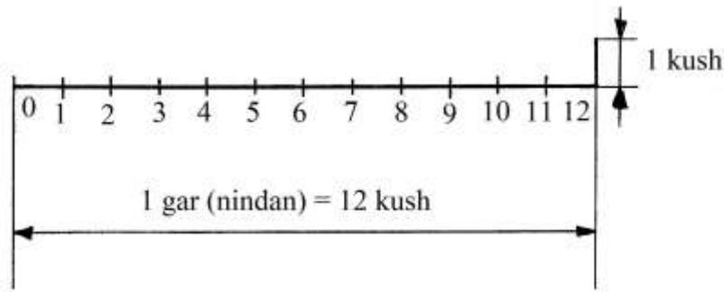
I Sumeri calcolavano l'inclinazione o *pendio* di una scarpata in pendenza nel modo descritto nella figura che segue:
