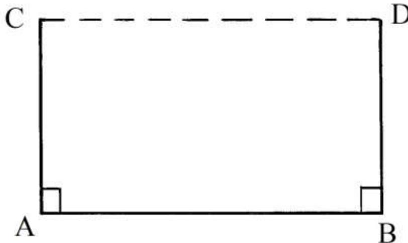
Ai suoi vertici costruivano le perpendicolari (in figura sono rivolte verso l'alto). A partire dai punti A e B riportavano due misure (AC e BD) di uguale lunghezza. CD completa la figura rettangolare.
