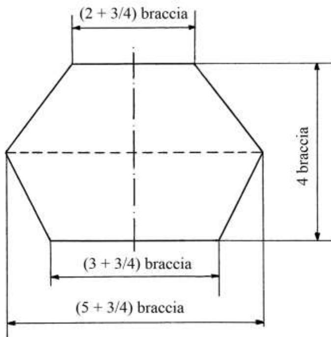
Una buca ha diametro al fondo lungo  $(3 + \frac{3}{4})$  braccia, alla bocca  $(2 + \frac{3}{4})$  e a metà altezza il diametro è  $(5 + \frac{3}{4})$  braccia. È profonda 4 braccia.
