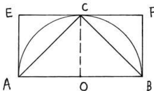
L'arco  $ACB$  è lungo  $a$ ,  $AB$  è il diametro  $d$  e la freccia  $OC$  è un raggio  $r$ .
