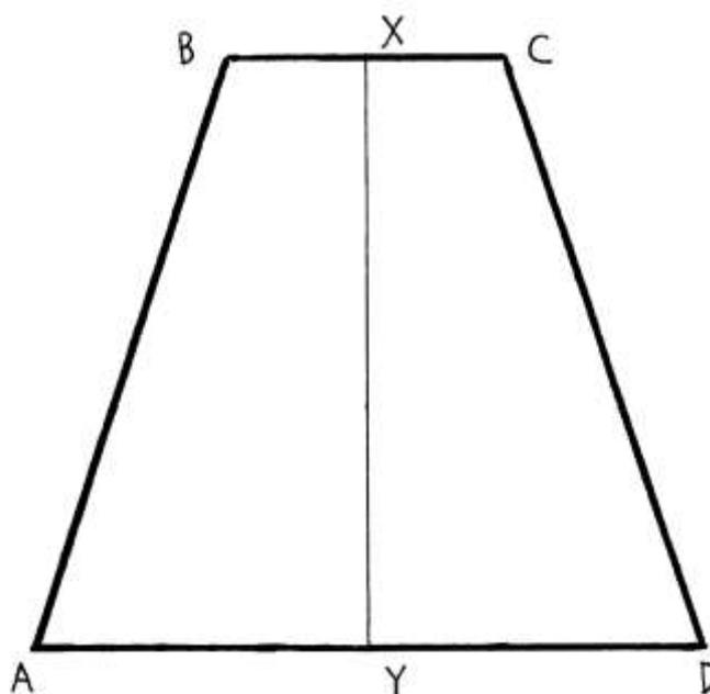
Il segmento XY è la mediana del trapezio isoscele e un suo asse di simmetria. Esso collega i punti medi delle due basi, X e Y.
