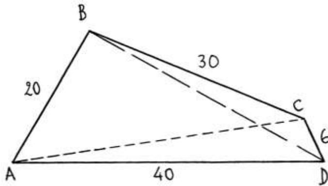
Una diagonale divide il quadrilatero in due triangoli, figure delle quali è facile calcolare le aree soltanto conoscendo le lunghezze di tutti i lati.
