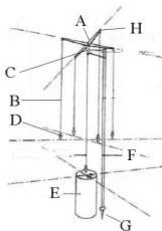
Nella parte superiore il ferramento terminava con un supporto sporgente, il *rostro*, recante due estremità cilindriche cave: nella seconda cavità era conficcato il perno che reggeva la *squadra* orizzontale con bracci ad angolo retto. Il rostro poteva ruotare in un piano orizzontale, senza ostacolare l'uso dello strumento. Anche la squadra poteva ruotare, sempre in un piano orizzontale.
