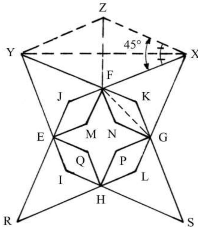
I segmenti  $YZ$  e  $YF$  hanno la stessa lunghezza di quelli  $FX$  e  $ZX$ : i triangoli isosceli  $YZF$  e  $ZFX$  sono triangoli di Cordova e hanno le stesse dimensioni di quello  $FXG$ .
