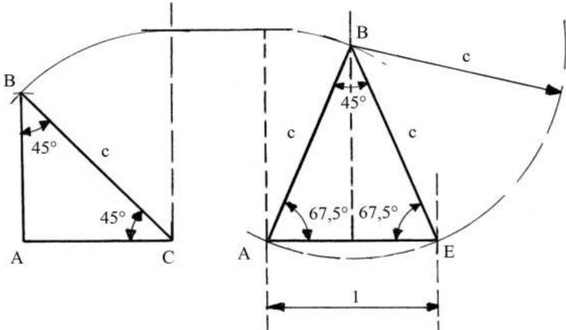
Costruire il triangolo isoscele ABE (a destra nella figura) con la base AE *convenzionalmente* lunga  $l$ . Come è evidente dalla figura, i lati del triangolo isoscele, AB e BE, per costruzione, hanno lunghezza uguale a C, come quella dell'ipotenusa BC della figura a sinistra.
