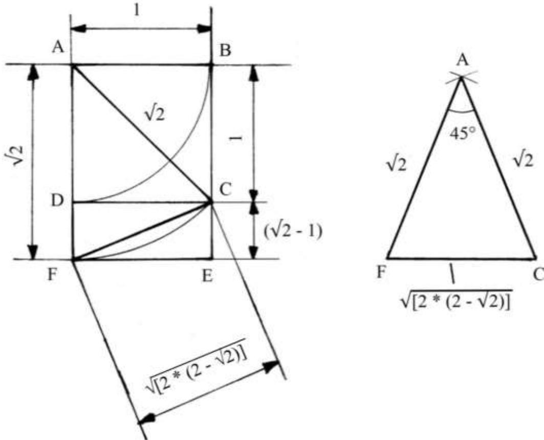
A destra, il triangolo di Cordova FAC è disegnato ruotato, in senso orario, con il lato di base FC orizzontale.
