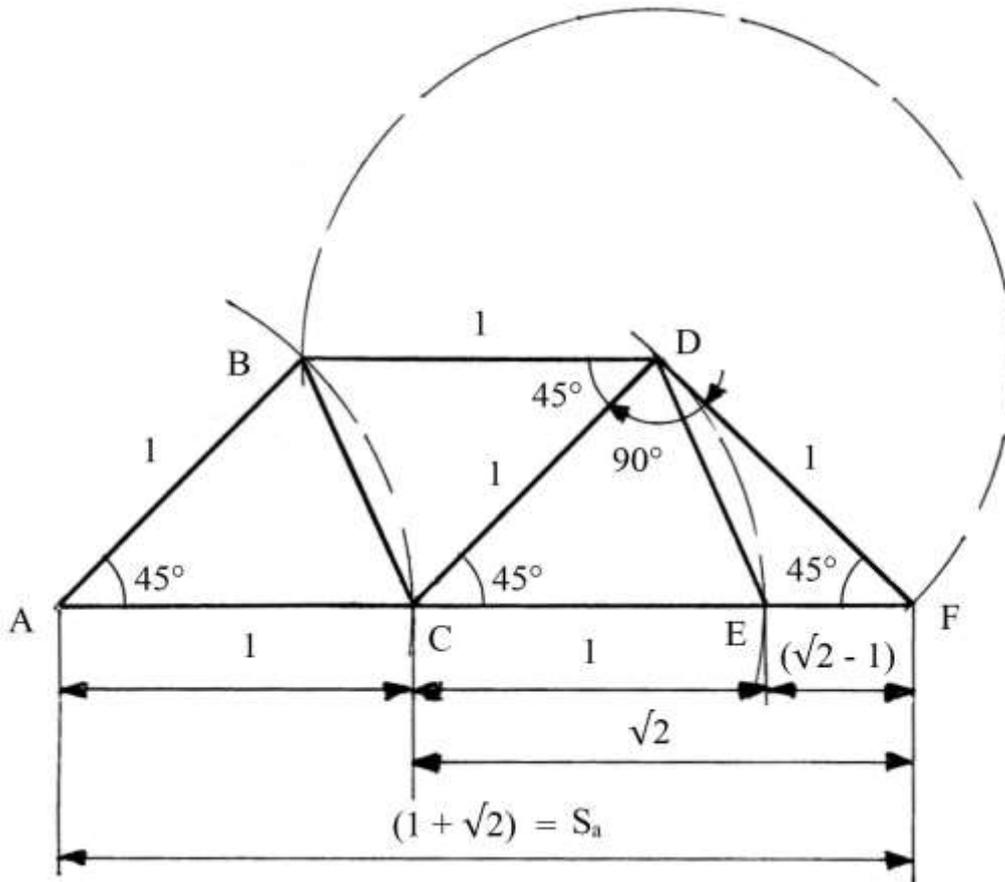
Fare centro nel punto D e con raggio DB (= 1) tracciare un arco da B fino a intersecare il prolungamento di AE nel punto F.
