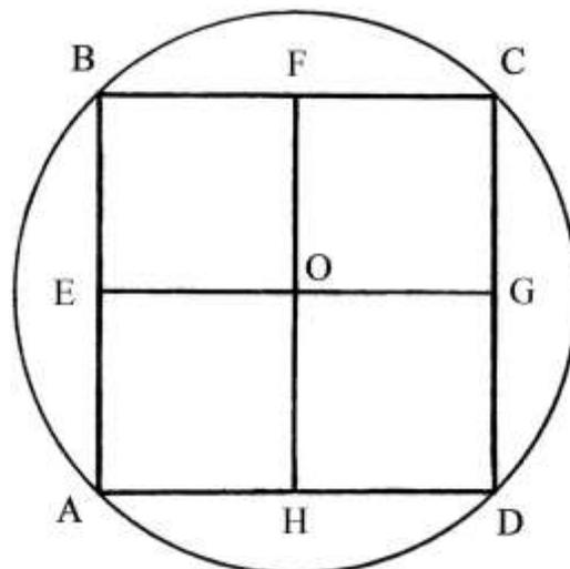
Le misure in croce consistono nella tracciatura delle mediane del quadrato, EG e FH, e nella loro misurazione.
