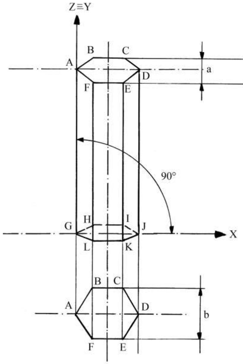
È da notare la mancanza di parallelismo dei quattro spigoli obliqui della faccia superiore e i corrispondenti spigoli di quella inferiore, come è facilmente verificabile confrontando i segmenti AF e GL: inoltre gli spigoli obliqui della faccia inferiore sono più corti di quelli corrispondenti della faccia superiore. Tutto ciò è dovuto anche allo scorciamento prospettico.
