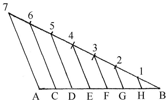
In questo secondo caso, il punto terminale, 7, viene collegato con il vertice A e i segmenti successivi sono disegnati parallelamente a A-7, a partire dai punti 6, 5, 4, 3, 2, 1, fino a intersecare il segmento AB nei punti C, D, E, F, G e H.
