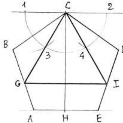
Tracciare l'altezza CH e perpendicolarmente ad essa una retta passante per il punto C.
