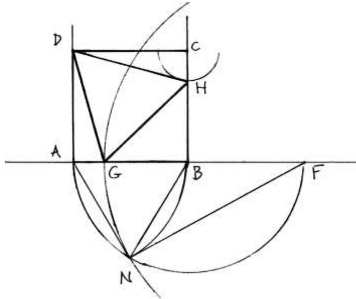
Con raggio AB fare centro in A e in B: si ottengono i punti N e F (il segmento BF ha la stessa lunghezza di AB).
