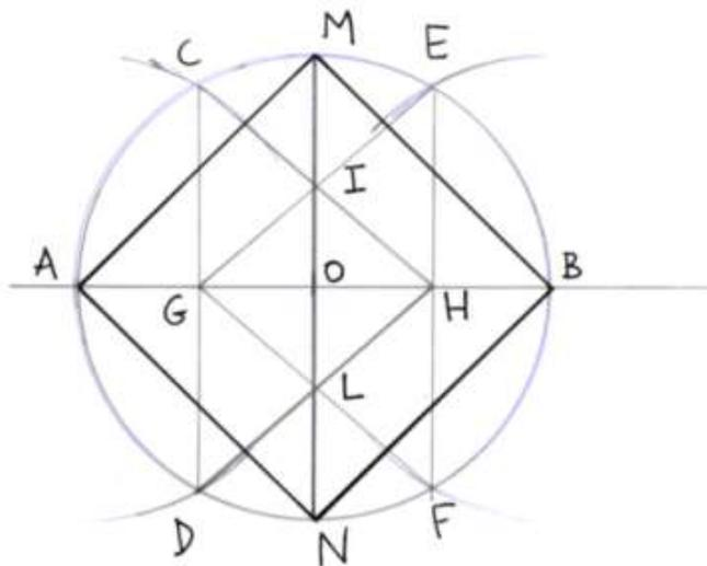
Facendo centro in A e in B (con l'apertura di compasso *fissa*) si trovano i punti C, D, E e F. Tracciamo le corde CD e EB: esse individuano i punti G e H sul diametro orizzontale. Disegniamo i segmenti GE, GF, HC e HD: le loro intersezioni sono i punti I e L. Per questi ultimi passa il diametro verticale MN che fornisce i due vertici mancanti del quadrato.
