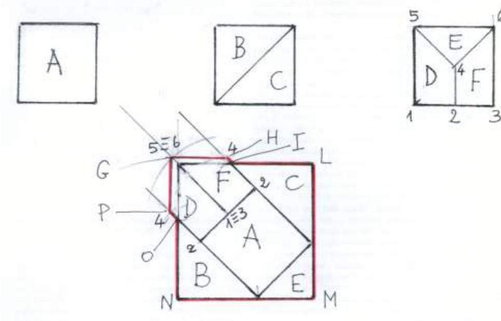
La soluzione adottata dagli artigiani non forniva un quadrato perfetto, ma un poligono irregolare più complesso e ciò a causa del posizionamento delle tre parti – D, E e F – del terzo quadrato. Il poligono evidenziato in *rosso* nella precedente figura è irregolare: GHILMNOP non è un quadrato perché possiede quattro spigoli per così dire *sporgenti*: OP, PG, GH e HI.
