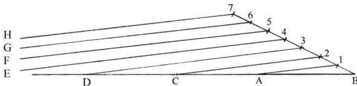
Il segmento  $AB$  deve essere ingrandito un numero  $n$  di volte, ad esempio 7 come in figura. A partire dal punto  $B$ , tracciare una semiretta inclinata e di lunghezza a piacere. Su di essa riportare dal punto  $B$  sette volte una lunghezza a piacere: si determinano i punti 1, 2, 3, 4, 5, 6 e 7.
