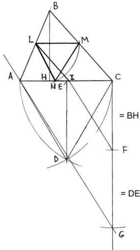
Tracciare una retta passante per i punti A e G e parallelamente ad essa disegnare un segmento da F fino a intersecare il lato AC in un nuovo punto, I.
