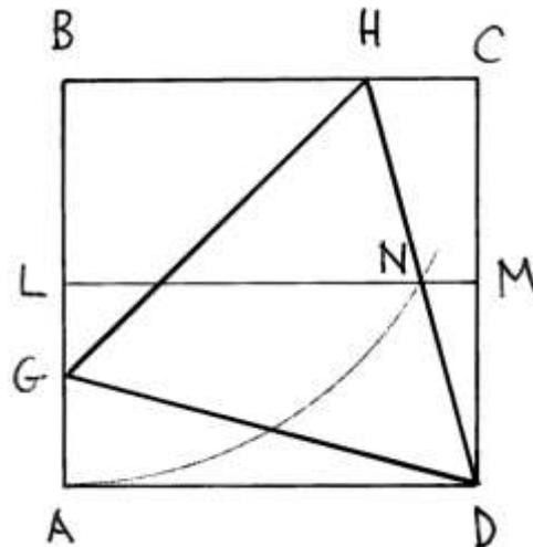
Disegnare il segmento passante per i punti D e N, fino a intersecare BC in un nuovo punto, H: DH è il primo lato del triangolo equilatero.
